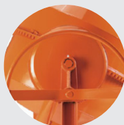
Desmultiplicação volante Standard 200 / 250 / 320 / 500 Opcional 180
